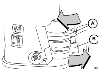
Imagen 3-2. Válvula de combustible y cebador
